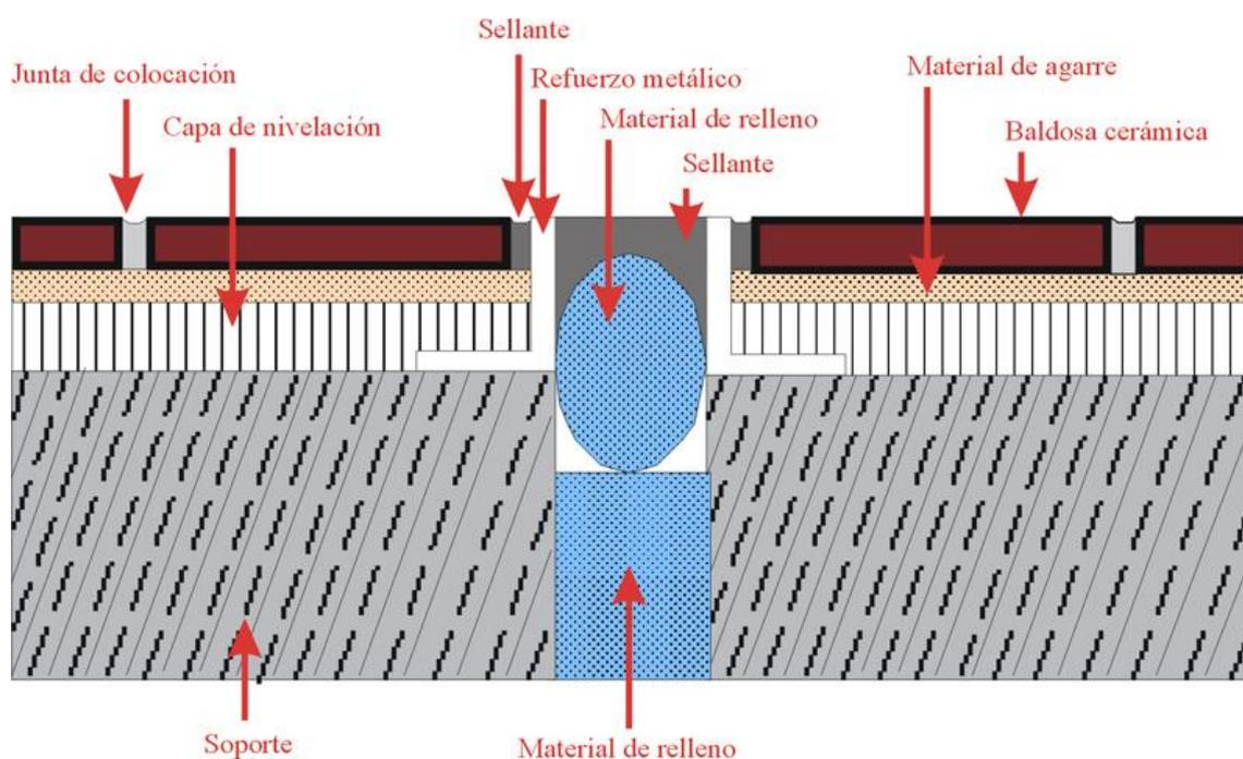
Deben respetar, como mínimo, la anchura de la junta sobre la que se ubican en toda su longitud y sin interrupciones. En juntas de control y hormigonado, sobre soleras de hormigón, se les asigna una anchura mínima de 10-12 mm, en toda la sección del recubrimiento. Si son de ejecución manual, deben utilizarse sellantes con una deformabilidad permanente nunca inferior al 15 %, también denominada factor de acomodación del movimiento (FAM).
