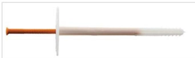
Taco de polipropileno con clavo metálico para instalación por percusión, apto para soportes A, B, C, D o E.
